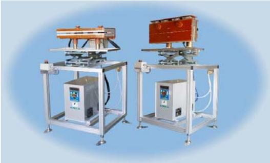
本事例は、自動車部品の押出成型時の素材の鈍しや接着剤硬化・樹脂被覆の成型に連続加熱を行う為の装置事例です。
